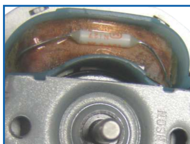
Motor sa termičkom zaštitom Motor with thermal protection
